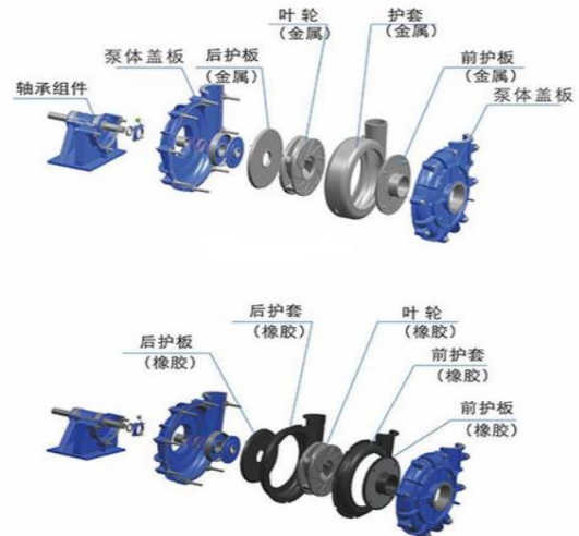
图表 13: 渣浆泵工作部备件结构图
